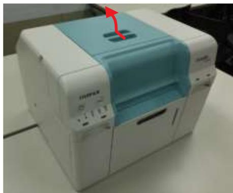
13. Togliere il nastro protettivo (in 3 punti) dall'interno della stampante e rimuovere il materiale protettivo.
